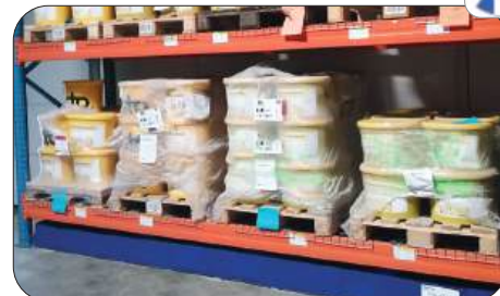
Bacs souples en PVC à poser au sol pour les niveaux 0 des rayonnages
